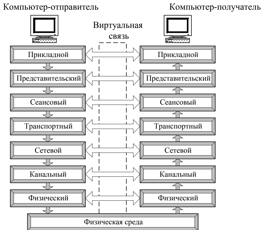
Рисунок 3.2 Схема взаємодії комп'ютерів у базовій еталонній моделі OSI
