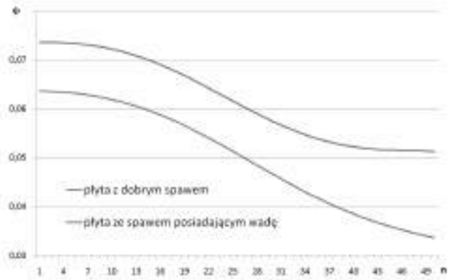
Rys. 6. Charakterystyki tłumienia płyty dobrze pospawanej i płyty posiadającej wadę w spoinie typu przeklejenie brzegowe
